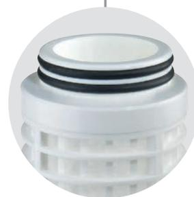
Configuration à montage rapide avec collier à double joint torique de 57 mm. Convient pour boîtiers Plus 3P CX et K DP.
