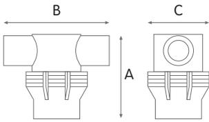
MICRO是Atlas Filtri系列中最小的过滤器，3/8英寸塑料BSP接口，其缩小的尺寸专为空间有限的设备设计，例如喷水清洁剂，高压清洗机以及微灌溉等多种应用。
